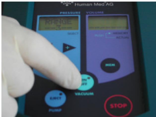
Über den **Drehregler** (1) an der Gerätefront kann das gewünschte Vakuum im Bereich von 0 bis minus 800 mbar eingestellt werden.
