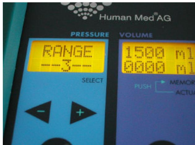
Dieser Vorgang kann mehrmals wiederholt werden. Im rechten oberen Display wird dann der Gesamtverbrauch angezeigt, während im rechten unteren Display immer die beim jeweiligen Absaugvorgang verbrauchte Flüssigkeitsmenge angezeigt wird
