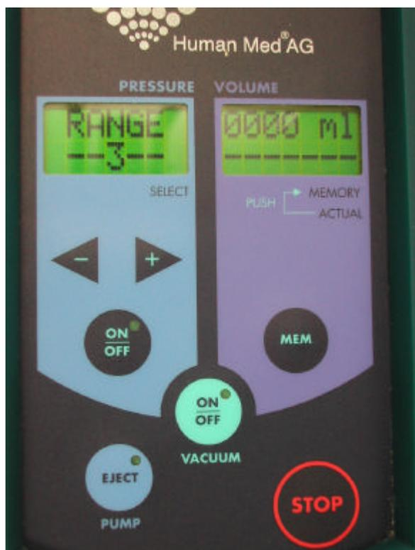
C) Über die +/- Taster ist der Druckbereich (RANGE 1 bis 5) auszuwählen. Der voreingestellte Druckbereich wird dabei im Display links angezeigt.
