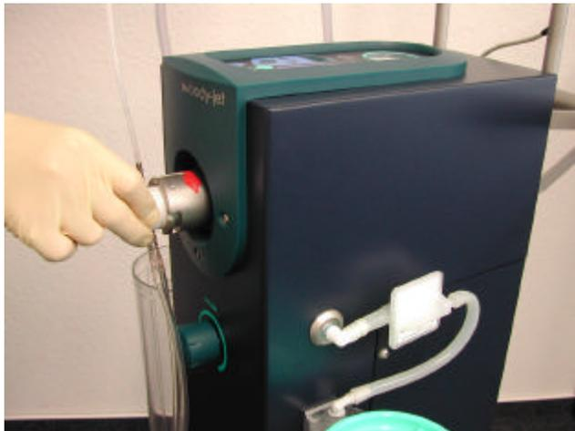
Entfernen Sie die Verschlusskappe von der Aufnahme für den Druckcontainer durch Linksdrehung. Der Druckcontainer ist in die Aufnahme einzuführen
