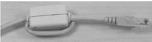
Bild 6-8. Ferritkern korrekt angebracht
