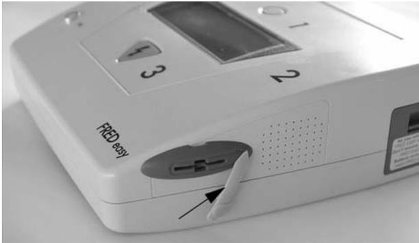
Bild 6-3. Entfernen der Abdeckung
